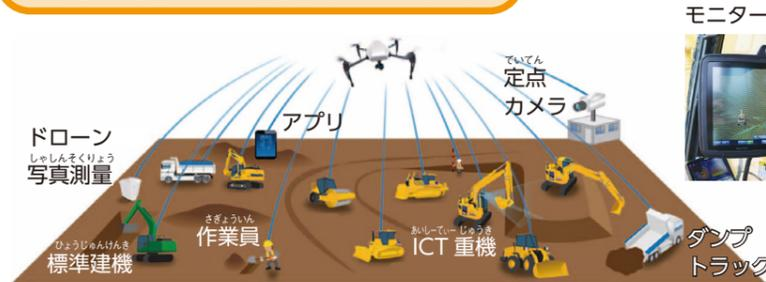
通信技術などの発達により、工事現場の管理方法や重機の操作方法は進化しています。例えば、広い工事現場の全体や、重機や人がどの場所で作業しているのかも、モニターを通して一目ではあくできます。また、重機の遠く操作や半自動操縦化も進んでいます。
